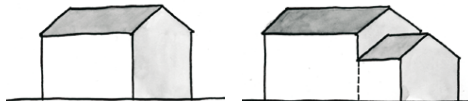
Corps principal et annexe (bâtiment secondaire)
